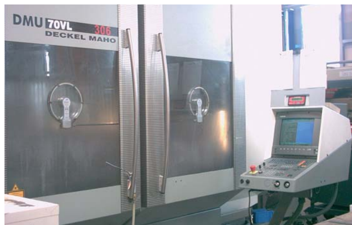
BRANKAMP CMS an einer MAHO DMU 70VL. Das 5-achsige Bearbeitungszentrum bearbeitet hochpräzise Teile. Die VL verfügt über einen Doppeltisch und zwei Arbeitsräume und ermöglicht so eine Pendelbearbeitung.
