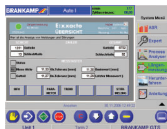
ProcessMonitoring und Längenmessung auf einem Monitor; gemessen wird direkt in der Maschine
