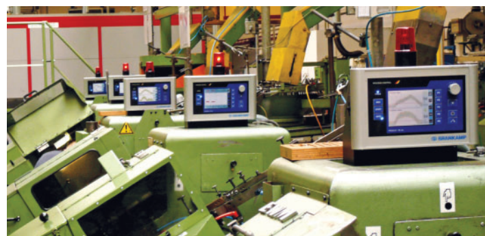
Das moderne und zukunftsorientierte Maschinen- und Werkzeugsicherungs-System PK 4U. Die BRANKAMP-Innovation überwacht sowohl Walzkräfte als auch Spurlage an Gwindewalzmäschinen.
