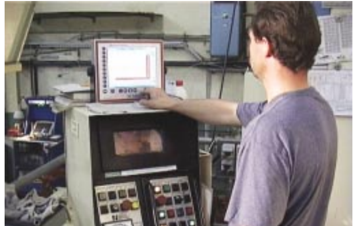
BRANKAMP Prozessüberwachungssystem unterstützt den Werker an einer FORMAX Presse
