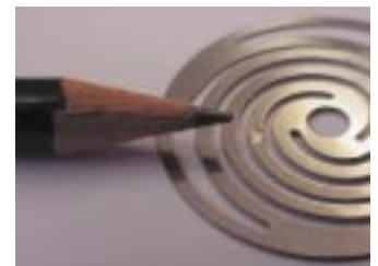
Bild 1: Wandernde Butzen, die zu einer Beschädigung geführt hätten (Akustik)
