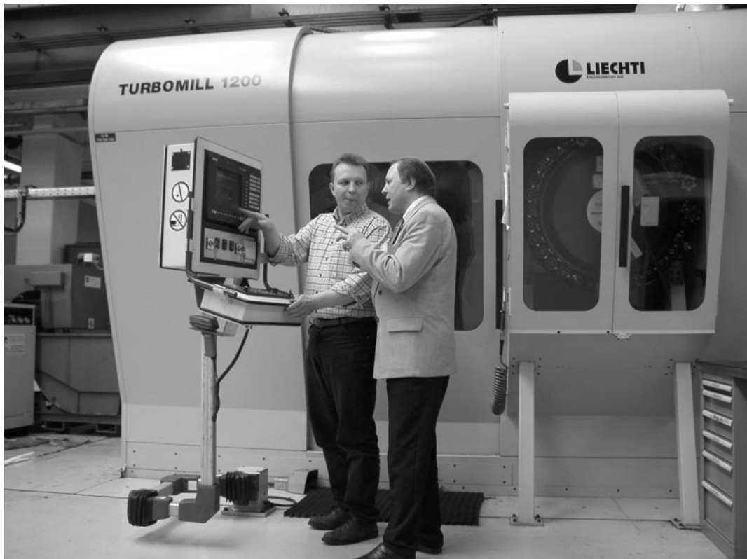
Christian Grzegorzek, Leiter der Instandhaltung bei Siemens Power Generation in Mülheim/Ruhr; und BRANKAMP-Prokurist Werner Ebeling an einem Liechti-HSC-Fräsezentrum mit steuerungsintegriertem ProcessMonitoring
