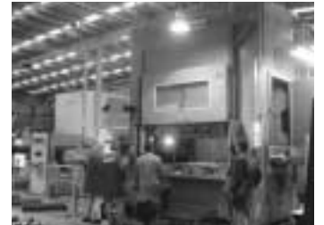
ProcessMonitoring mit der BRANKAMP PK 550 an einer 315-Tonnen-Hydraulikpresse
