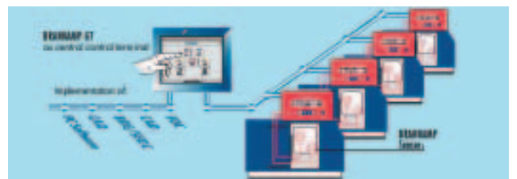
Zentrale und dezentrale Bedienung mehrerer Maschinen durch BRANKAMP B100 und BRANKAMP GT
