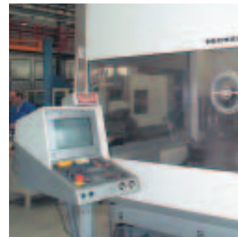
Deckel Maho Gildemeister DMU125p Bearbeitungszentrum: Formenbau Einzelteilerfertigung
