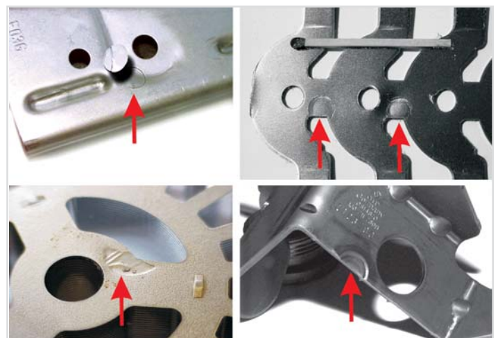
Stanzbutzen sind ein lästiges Problem, mit Ultra-Emission lassen sie sich vermeiden
