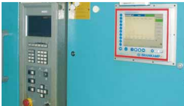
ProcessMonitoring von BRANKAMP an einer Index MS 42 C. Der NC-gesteuerte Mehrspindeldrehautomat wird für die Fertigung ungewöhnlich komplizierter Teile in der Klein- und Großserienfertigung eingesetzt.
