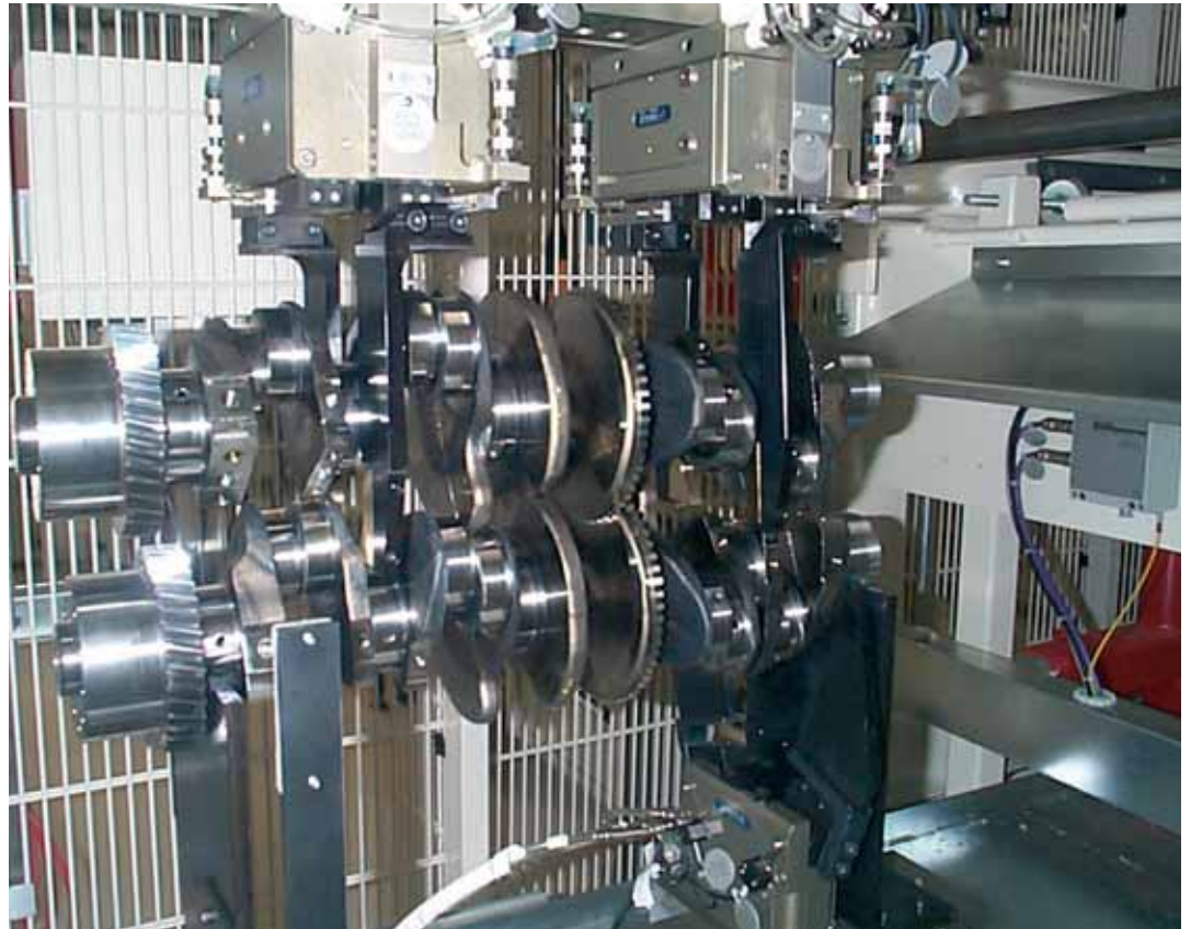
Ohne den BRANKAMP-Maschinenschutz wäre bei einer Kollision von zwei Kurbelwellen der Schaden immens.
