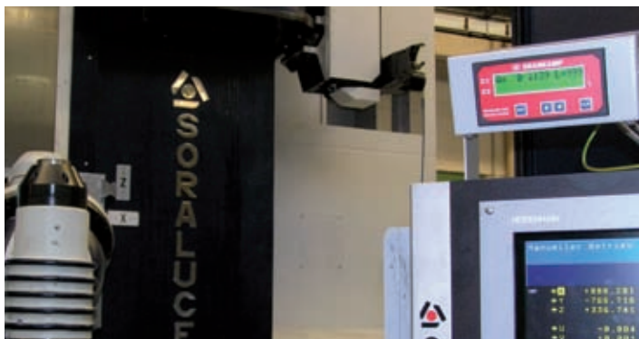
BRANKAMP CMS an einer Soraluce Fahrständerfräsmaschine mit einer X-Achse von 8,5 Metern Länge.
