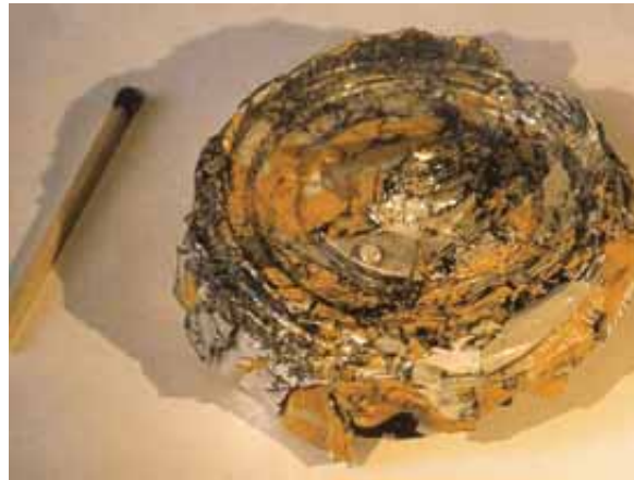
Mehrere nicht ausgeworfene Deckel beschädigen Maschine und Werkzeug
