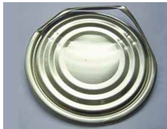
Auswurf Fehler beschädigen den Deckel
