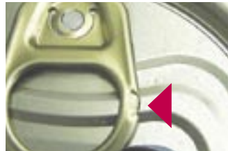
Bild 1: Fehlriehung Photograph 1: Rivet failure
