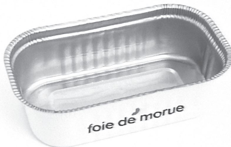
Bild 1: Falten durch zu geringe Niederhalterkraft Photograph 1: Rivet failure
