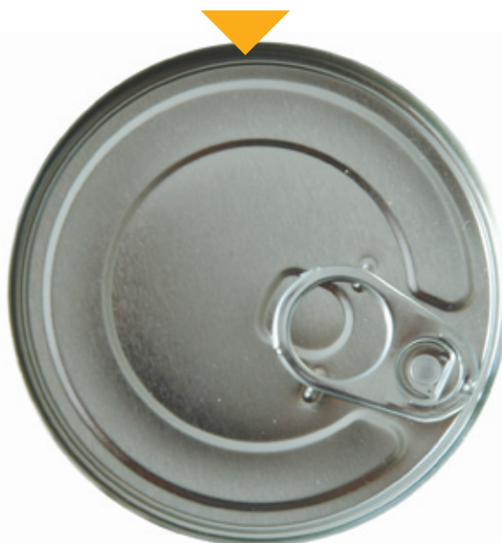
Bild 1: Überwachung der Einritztiefe Foto 1: Monitoring the scoring depth
