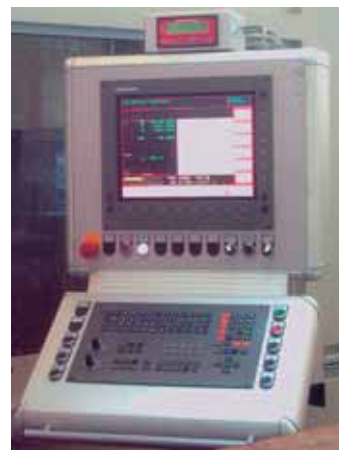
Vor Kollisionen und den Folgen geschützt: Das BRANKAMP CMS-System an einem Bearbeitungszentrum im Einsatz.
