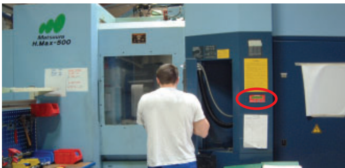
Ein BRANKAMP CMS-System an einer Matsuura H. Max - 500. Auf dem Bearbeitungszentrum werden unter anderem Flugzeugteile für Airbus, Bombardier und Eurocopter hergestellt.
